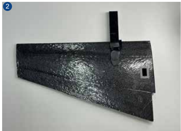
Устанавливаем крепление для поворотной системы.
